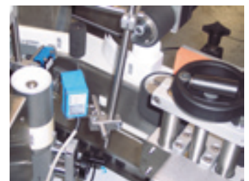
Sensori di controllo etichetta Label control system Système de contrôle étiquette
